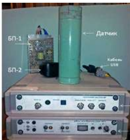
Рисунок 16. Структурная схема и общий вид эталонного гелий-цезиевого магнитометра
