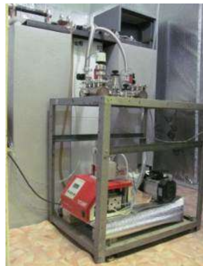
Рисунок 7. Лазерный интерференционный ртутный манометр (ЛИРМ) с диапазоном измерений 0,1-130 кПа
