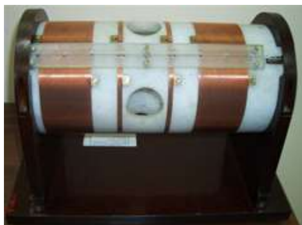
Рисунок 19. Общий вид эталонного соленоида градиента магнитной индукции СГМИ-1
