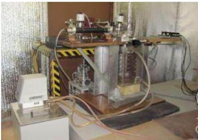
Рисунок 6. Лазерный интерференционный масляный манометр (ЛИММ) с диапазоном измерений 0,1-1000 Па
