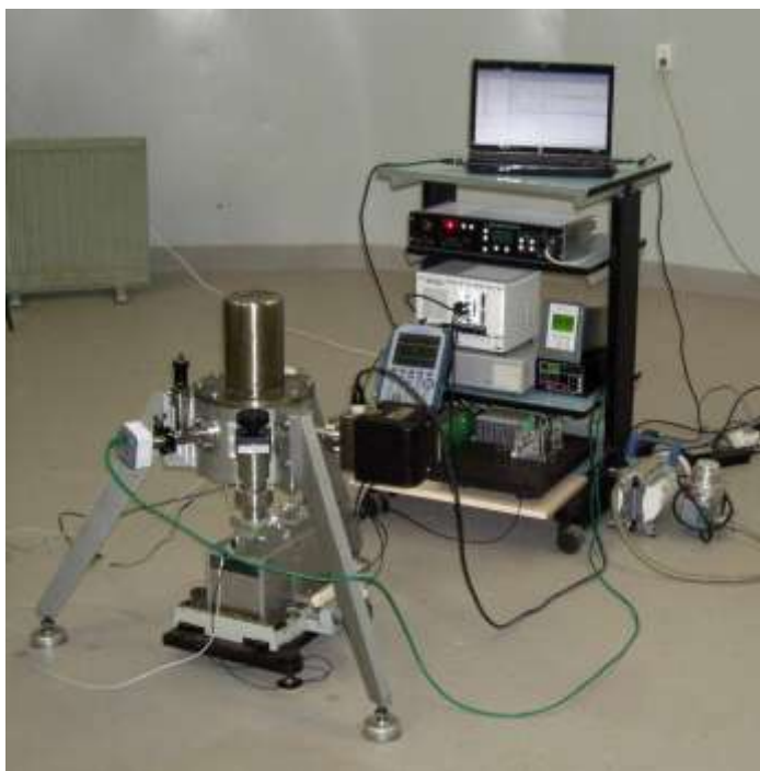
Рисунок 15. Абсолютный баллистический гравиметр ВНИИМ-АБГ-1
