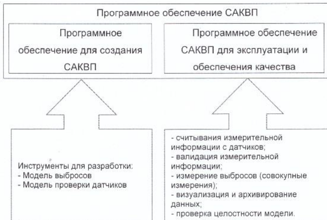
Рисунок 2. Функциональная схема программного обеспечения САКВП.
