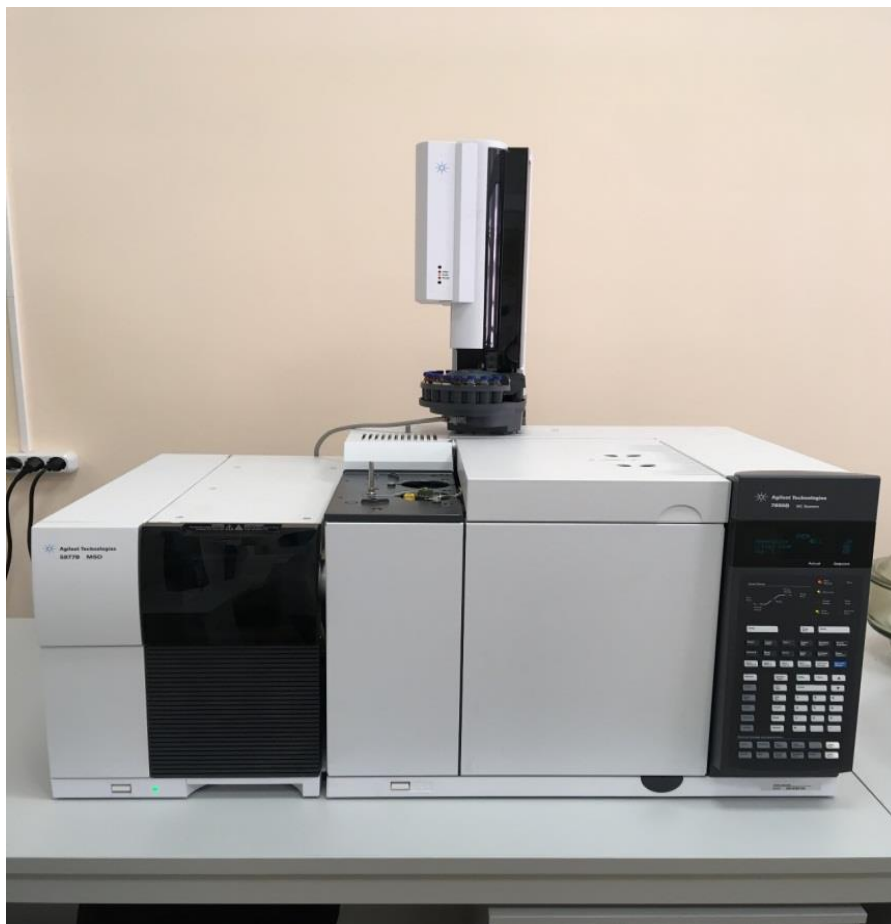
Рисунок 4.5 –Хроматограф газовый Agilent 7890В с масс-спектрометрическим детектором Agilent 5977В, входящий в состав установки А 1
