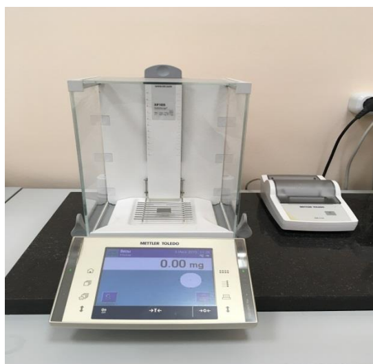
Рисунок 4.6 –Весы электронные специального класса точности XP 105 DR, входящие в состав установки А 10
