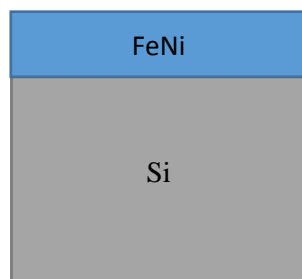
Рисунок 18 – Схема покрытия железо-никель на кремнии
