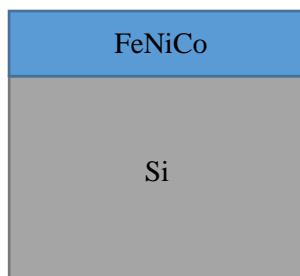
Рисунок 20 – Схема покрытия железо-никель-кобальт на кремнии
