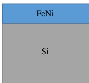
Рисунок 38 – Схема покрытия стандартных образцов
