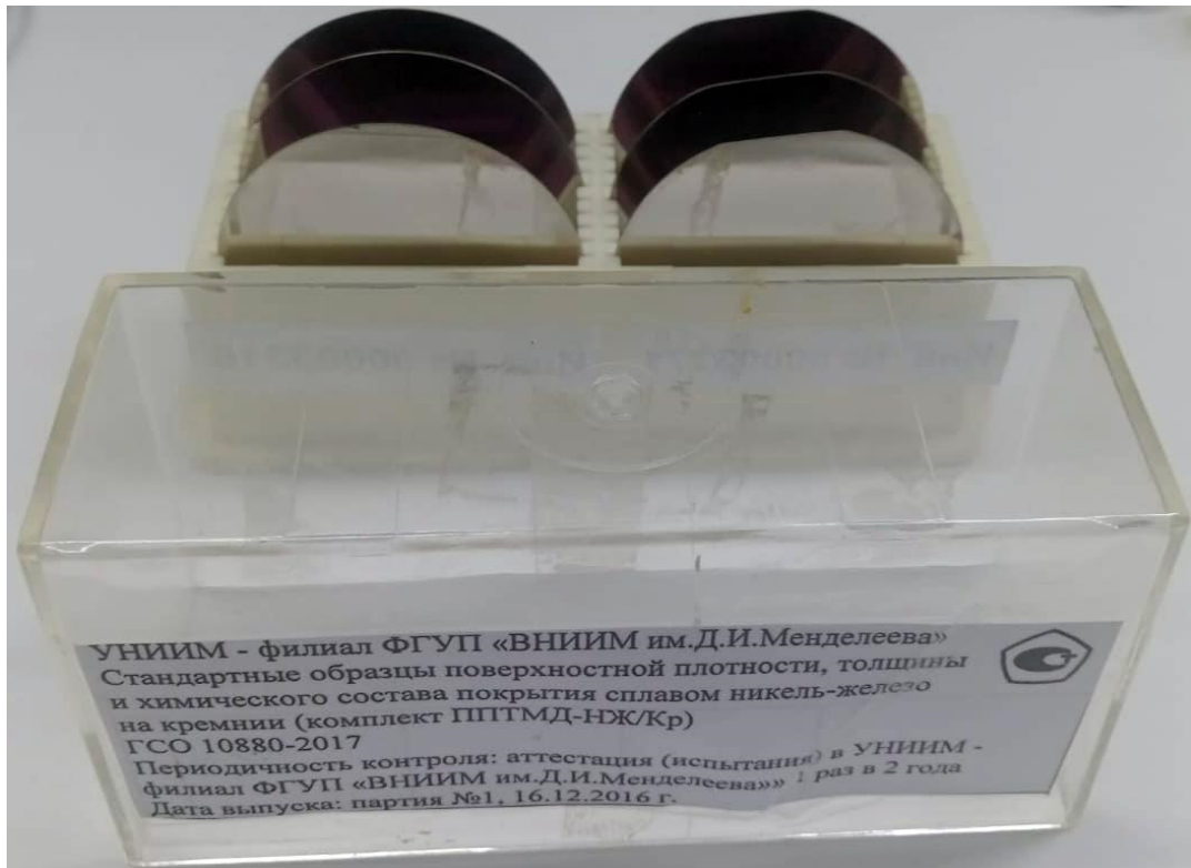
Рисунок 39 – Внешний вид ГСО 10880-2017 и эталонов сравнения FeNi/Si
