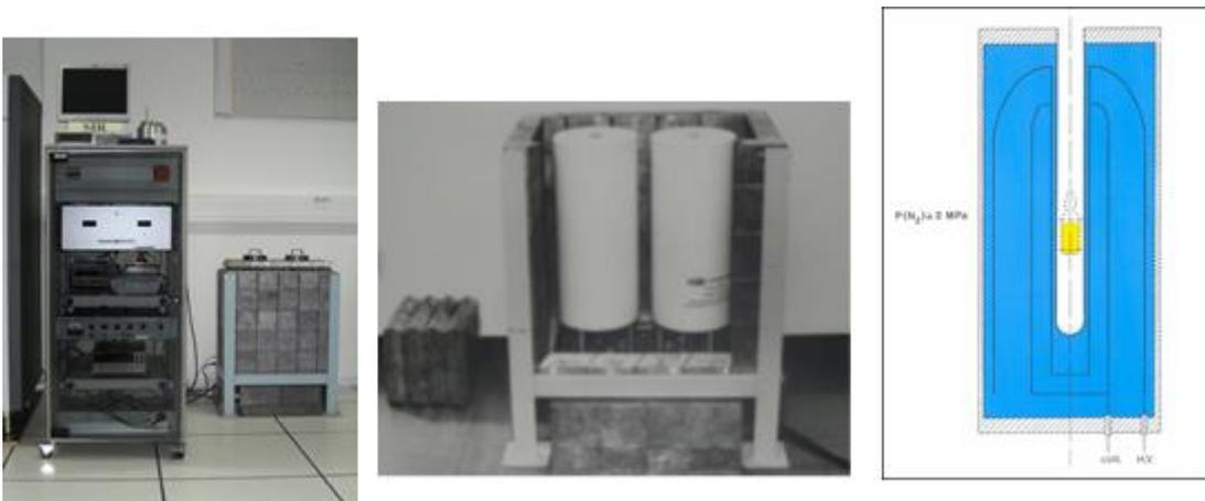
Рисунок 40 – Оборудование международной референтной системы измерения активности радионуклидов (SIR)
