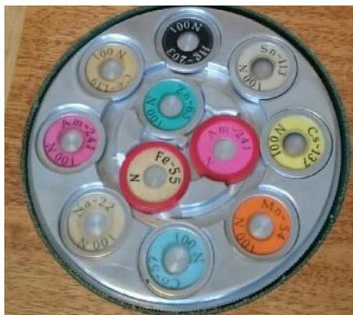
Рисунок 11 – Общий вид радионуклидных источников ИМН-Г-1
