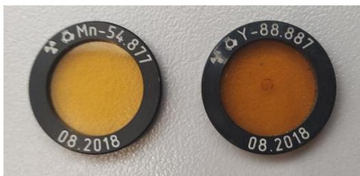
Рисунок 46 – Точечные радионуклидные источники  $^{54}\text{Mn}$  и  $^{88}\text{Y}$
